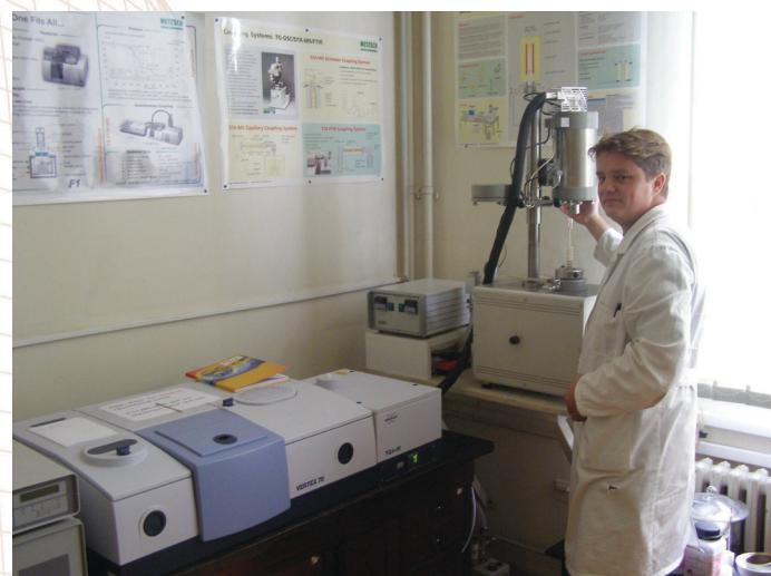
Mr. sc. Ivan Brnardić ponosno predstavlja uređaje za diferencijalnu pretražnu kalorimetriju i termogravimetrijsku analizu
