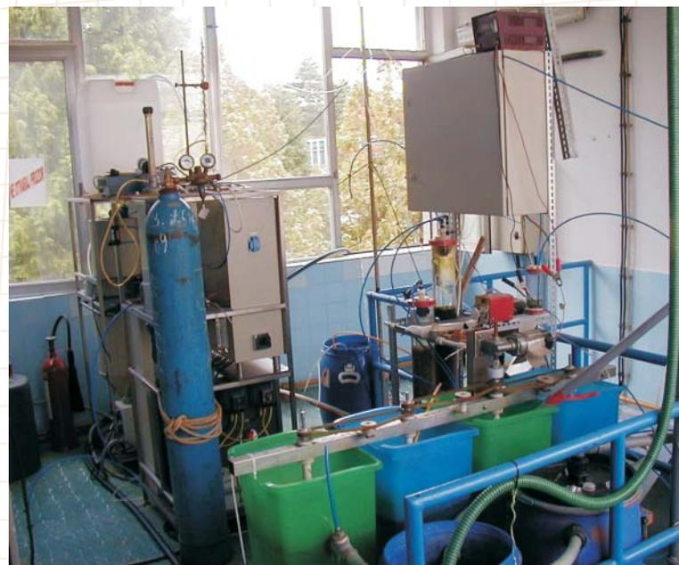
Detalj pilot-postrojenja za uklanjanje arsena iz vode za piće u Osijeku.
