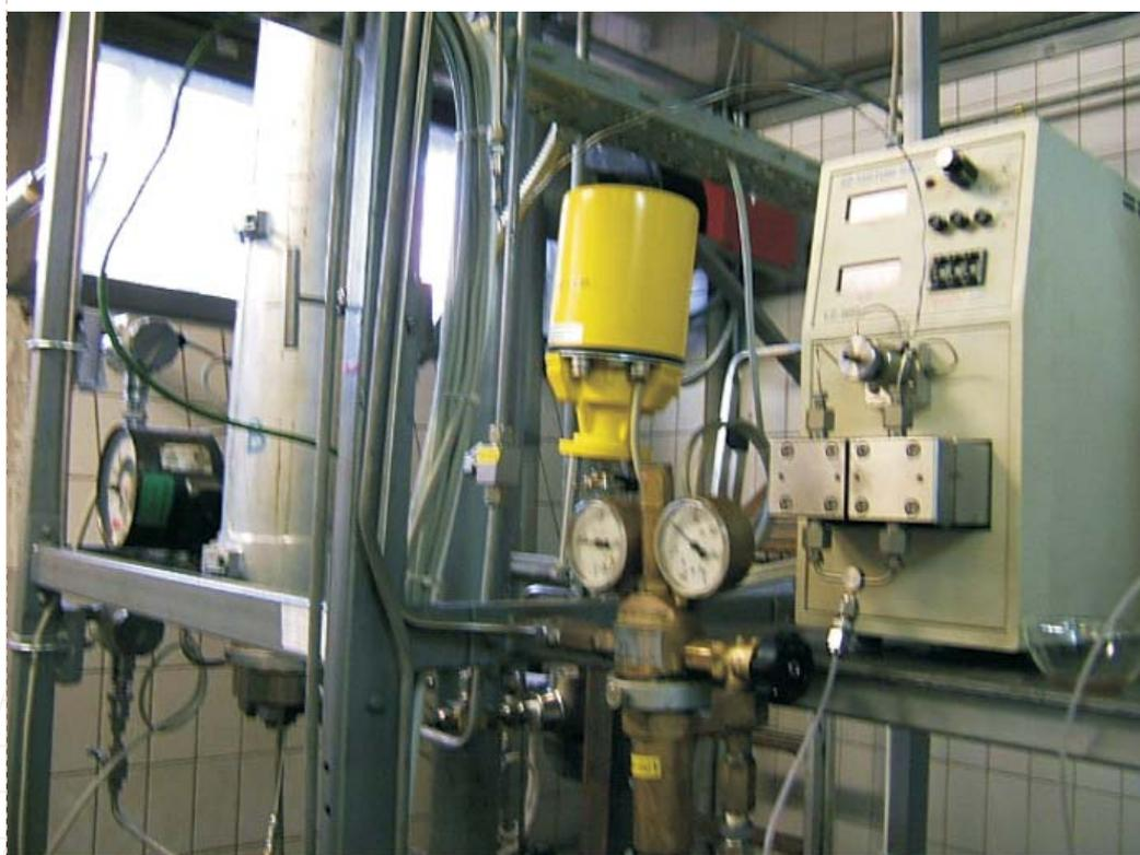
Laboratorijska aparatura s reaktorom, regulacijskim ventilom i pumpom
