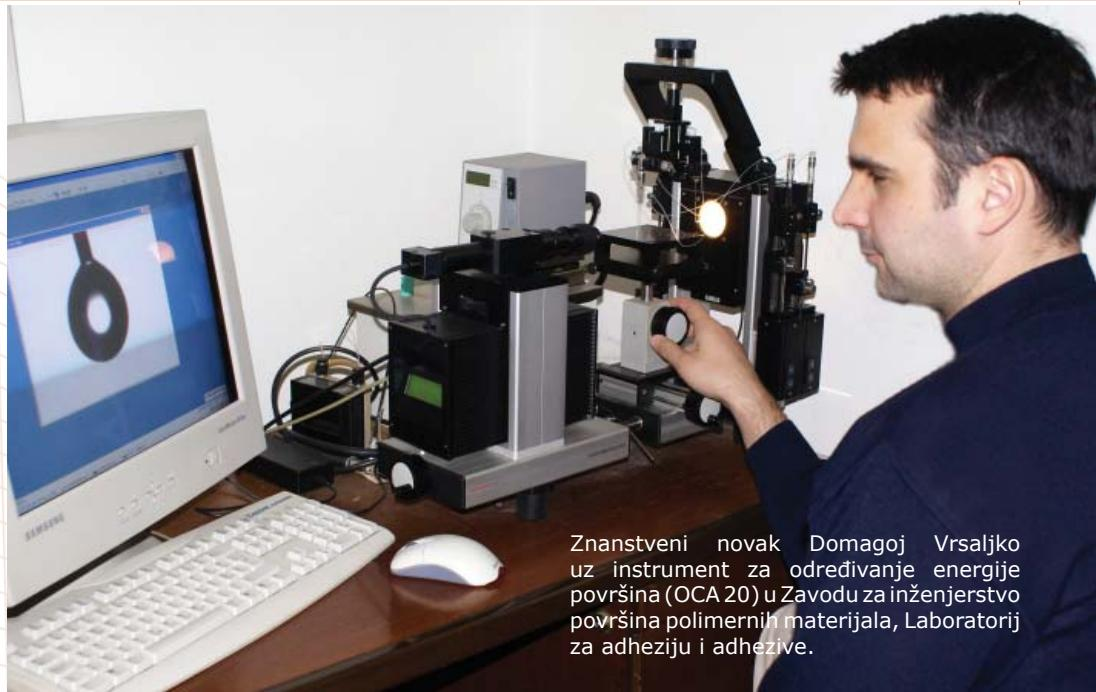
Znanstveni novak Domagoj Vrsaljko uz instrument za određivanje energije površina (OCA 20) u Zavodu za inženjerstvo površina polimernih materijala, Laboratorij za adheziju i adhezive.
