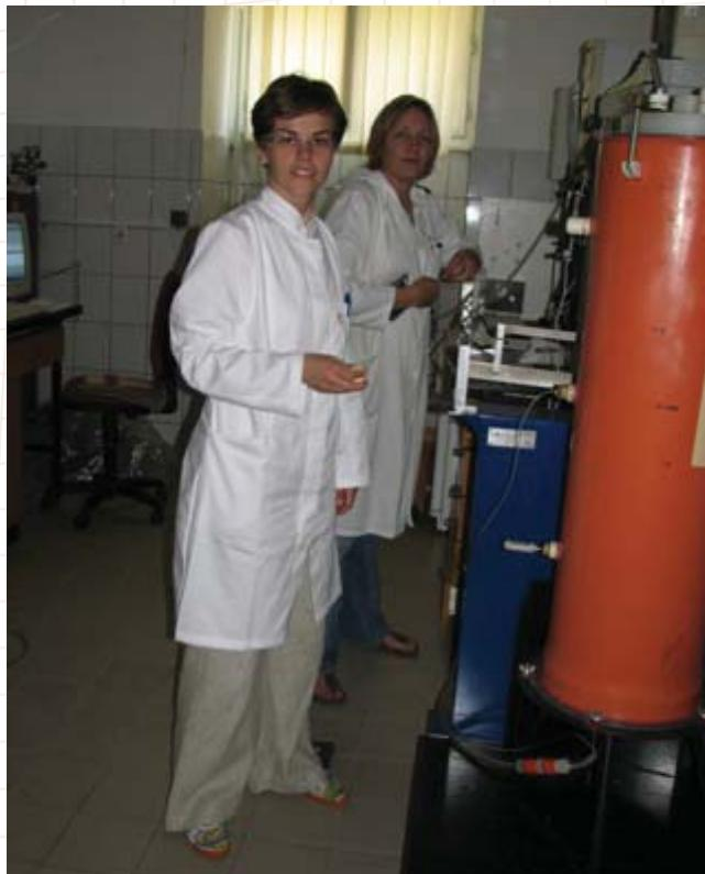
Laboratorij za kompostiranje s procesnom opremom za automatsko vođenje procesa kompostiranja u zatvorenim reaktorima.
