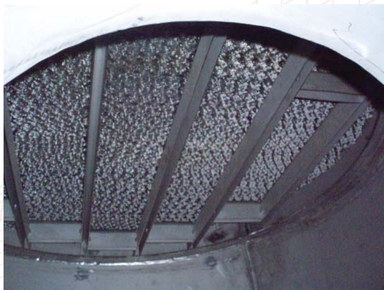
Ugrađeno strukturirano punilo kolone na svome nosaču.
