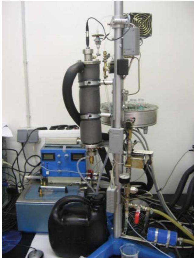
**Slika 2.** Aparatura za kolonsku adsorpciju
