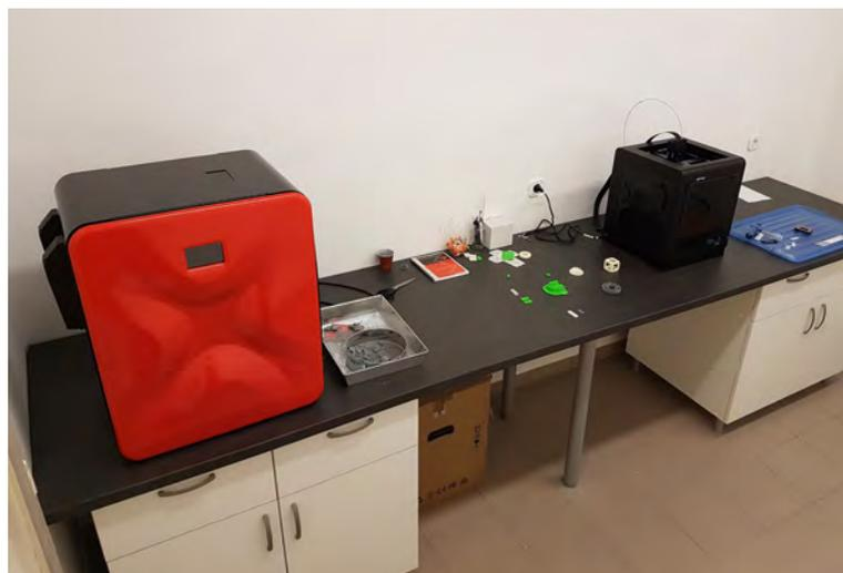
SLS i FDM 3D pisači u novouređenom Laboratoriju za aditivnu proizvodnju
